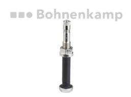
LKW-Felgenventil 83 MS für Alufelgen Metallventil, gerade, 83 mm lang für Ventilloch O 9.7 mm
