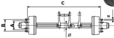
Rückmatikachse 5100/5100/4300 kg bei 40 km/h
