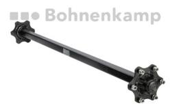
Laufachse 3500/4100/3000 kg bei 40 km/h 2150 mm Spur, Achskörper 60 mm VKT 6/160/205, M18 x 1.5
