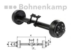
Bremsachse 6500/7500/6000 kg bei 40 km/h 1360 mm Spur, 6/160/205, M18 x 1.5, 70 mm VKT Bremse 300x90, 309E, Hebel mittig
