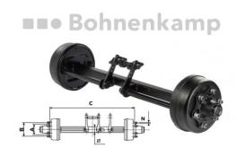
Bremsachse 4000/5000/3500 kg bei 40 km/h 1800 mm Spur, 6/161/205, M18 x 1.5, 60 mm VKT Bremse 300x60, 306E, Hebel mittig
