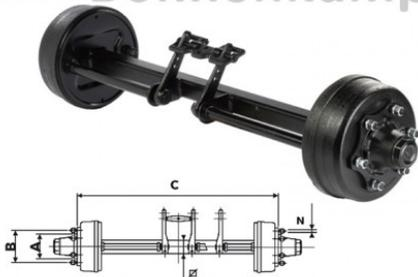
Bremsachse 8000/9000/7500 kg bei 40 km/h
