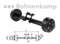
Bremsachse 6700/7500/6000 kg bei 40 km/h 1600 mm Spur, 6/160/205, M18 x 1.5, 70 mm VKT Bremse 300x90, 309E, Hebel 200 mm links versetzt
