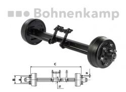
Bremsachse 4000/5000/3500 kg bei 40 km/h 1700 mm Spur, 6/160/205, M18 x 1.5, 60 mm VKT Bremse 300x90, 309E, Hebel mittig
