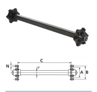
Laufachse 3500/4100/3000 kg bei 40 km/h 1360 mm Spur, Achskörper 60 mm VKT 6/160/205, M18 x 1.5
