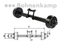
Rückmatikachse 5100/6000/4300 kg bei 40 km/h 2150 mm Spur, 6/161/205, M18 x 1.5, 70 mm VKT Bremse 300x90, 309R, Hebel 300 mm links versetzt
