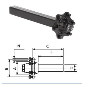
Laufachsstummel 1750/2050/1500 kg bei 40 km/h 204/250 mm lang, Achskörper 55 mm VKT 6/160/205/M18 x 1.5
