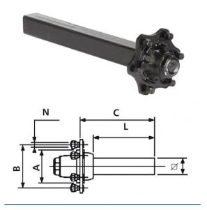
Laufachsstummel 2000/2500/1750 kg bei 40 km/h 698/750 mm lang, Achskörper 80 mm VKT 6/160/205/M18 x 1.5
