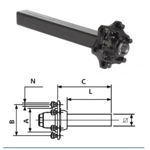
Laufachsstummel 1350/1600/1200 kg bei 40 km/h 253/300 mm lang, Achskörper 50 mm VKT 6/160/205/M18 x 1.5
