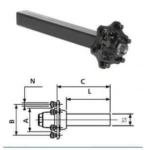
Laufachsstummel 825/975/725 kg bei 40 km/h 130/165 mm lang, Achskörper 40 mm VKT 5/66/112/M14 x 1.5, Typenschild lose
